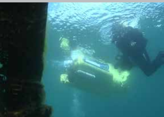
Das Mini-U-Boot soll Taucheinsätze von 3-4 Stunden in 40 Meter Tauchtiefe ermöglichen
