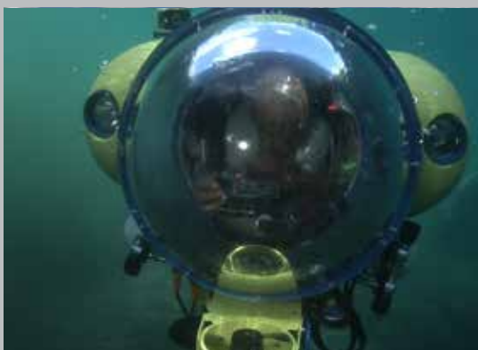
Das Mini-U-Boot soll Taucheinsätze von 3-4 Stunden in 40 Meter Tauchtiefe ermöglichen
